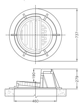
NO. 2 CATCH BASIN FRAME & COVER FOR ROLLED CURB & GUTTER
